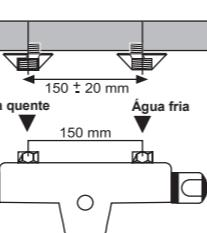
NB: Nos casos em que os tubos das entradas de água quente e água fria não tenham um entre-eixo padrão de 150 mm, utilizar as uniões excéntricas (fornecidas). Aparafusá-las aos tubos de alimentação (se necessário, envolvendo-as com fita Téflon para uma melhor estanquidade), em seguida apertar as rosáceas às uniões excéntricas, colocar as juntas na base das porcas de aperto da torneira e aparafusar a torneira às uniões excéntricas.
