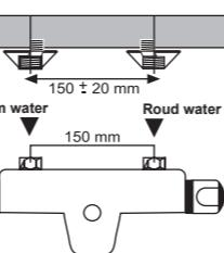
NB: Voor het geval dat de warme of koude waterleidingen geen standaard middenafstand van 150 mm hebben, de eccentriche tussenstukken (meegeleverd) gebruiken. Deze aan de waterleidingen vastschroeven (indien nodig er een teflontape omheen wikkelen voor een betere afdichting); vervolgens de rozetten op de eccentriche tussenstukken vastschroeven; de afdichtingen aan de onderkant van de klemmoeren van de kraan plaatsen en de kraan aan de eccentriche tussenstukken vastschroeven.
