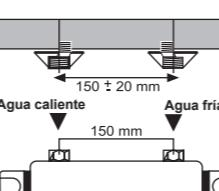
NOTA: en el caso de tuberías en las que la llegada de agua caliente y fría que no tengan la distancia estándar de 150 mm, utilizar los raccords de excentricas (incluidos).
