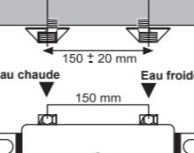
NB : Pour le cas où les tuyaux d'arrivées d'eau chaude et d'eau froide n'auraient pas un entraxe standard de 150 mm, utiliser les raccords excentrés (fournis). Visser ceux-ci aux tuyaux d'alimentation (au besoin en les entourant avec du ruban Teflon pour une meilleure étanchéité); visser ensuite les rosaces aux raccords excentrés ; mettre les joints au fond des écrous de serrage du robinet et visser le robinet aux raccords excentrés.
