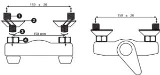
NOTA: en el caso de tuberías en las que la llegada de agua caliente y fría que no tengan la distancia estándar de 150 mm, utilizar los raccords de excéntricas (incluidos).
