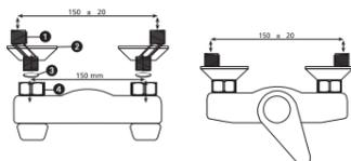
NB: Nos casos em que os tubos das entradas de água quente e água fria não tenham um entre-eixo padrão de 150 mm, utilizar as uniões excêntricas (fornecidas). Aparafusá-las aos tubos de alimentação (se necessário, envolvendo-as com fita Téflon para uma melhor estanquidade), em seguida apertar as rosáceas às uniões excêntricas, colocar as juntas na base das porcas de aperto da torneira e aparafusar a torneira às uniões excêntricas.
