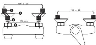
NB : Pour le cas où les tuyaux d'arrivées d'eau chaude et d'eau froide n'auraient pas un entraxe standard de 150 mm, utiliser les raccords excentrés (fournis). Visser ceux-ci aux tuyaux d'alimentation (au besoin en les entourant avec du ruban Teflon pour une meilleure étanchéité); visser ensuite les rosaces aux raccords excentrés ; mettre les joints au fond des écrous de serrage du robinet et visser le robinet aux raccords excentrés.
