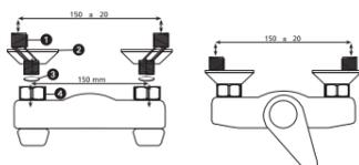
NB: Voor het geval dat de warme of koude waterleidingen geen standaard middenafstand van 150 mm hebben, de excentrische tussenstukken (meegeleverd) gebruiken. Deze aan de waterleidingen vastschroeven (indien nodig er een teflontape omheen wikkelen voor een betere afdichting); vervolgens de rozetten op de excentrische tussenstukken vastschroeven; de afdichtingen aan de onderkant van de klemmoeren van de kraan plaatsen en de kraan aan de excentrische tussenstukken vastschroeven.
