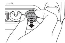
2. Changez le filtre à air. Enlevez le filtre à air usagé avec un objet pointu et introduisez le filtre à air neuf.
