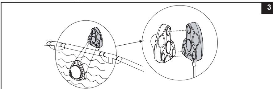
3. Ajustez manuellement la position de la lampe en faisant glisser l'émetteur.
