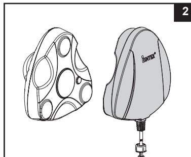
2. Placez l'émetteur (2) à l'extérieur de la piscine et la lampe (1) à l'intérieur, dans l'eau. Assurez-vous que l'émetteur soit correctement aligné avec les pôles magnétiques de la lampe. **Voir dessin (3).**
