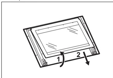
8. Nettoyez les panneaux de verre à l'eau savonneuse. Séchez soigneusement les panneaux de verre. Une fois le nettoyage terminé, remettez les panneaux de verre et la porte du four en place. Suivez les étapes ci-dessus dans l'ordre inverse.
