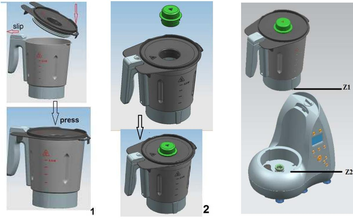
**Attention : si le couvercle n'est pas bien installé, vous ne serez pas en mesure de mettre l'appareil en marche.**
