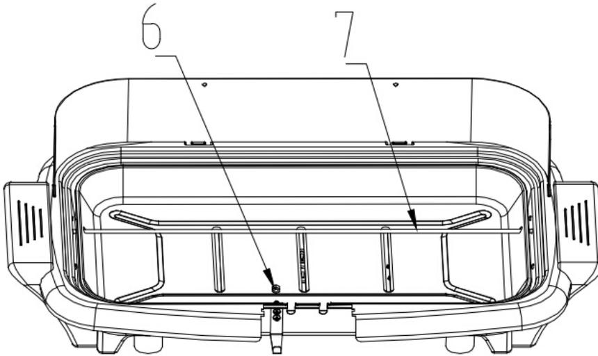
**Etape 4:** Insérez le tube métallique dans le plateau récupérateur de graisse (No.5).
