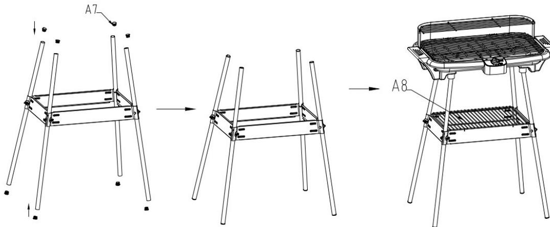
**A7. Bouchon en caoutchouc A8. Grille inférieure**
