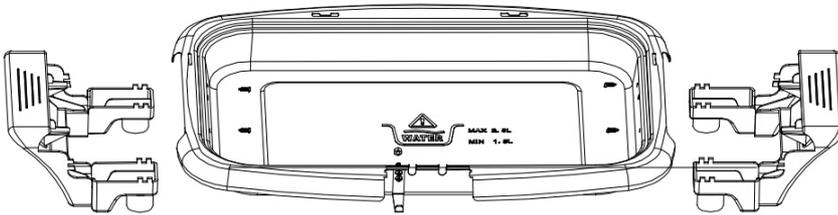
**Etape 2:** Fixez les poignées en plastique sur les deux côtés de la cuve par quatre vis.
