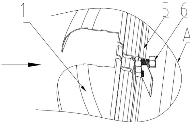
**Etape 6:** Placez le petit trou de la partie rainurée du plateau (No.5) sur la vis allongée, et fixez à l'aide du boulon (No.6).
