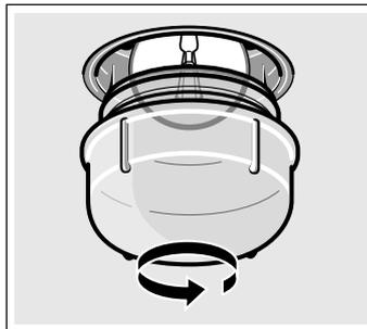
3. Remplacez l'ampoule par un modèle similaire.
