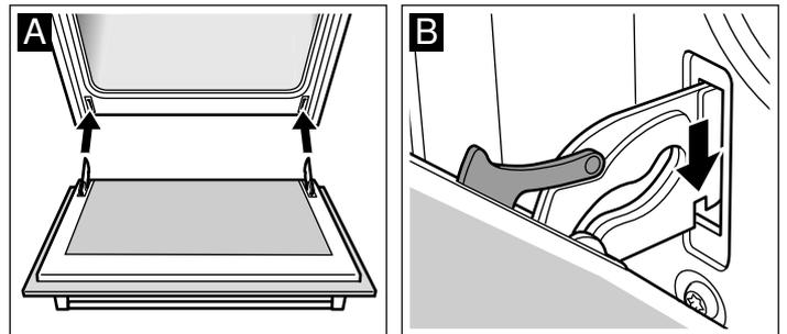
Une mauvaise mise en place des charnières peut provoquer le désalignement de la porte.
