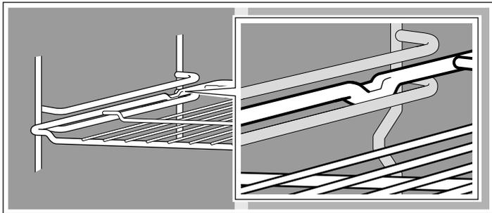
En fonction des équipements, si l'appareil dispose de rails d'extraction, ceux-ci s'engastrent légèrement lorsqu'ils sont entièrement retirés. Cela permet de placer facilement les accessoires. Pour déverrouiller, replacez les rails d'extraction à l'intérieur du four en exerçant une légère pression.
