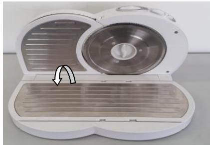
3. Dépliez le chariot protégè-doigt et posez-le sur la plateforme dans les encoches prévues à cet effet. Ensuite, faites coulisser le chariot protégè-doigt vers la gauche afin de le placer en position de départ.
