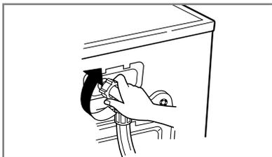
4. Resserrer le tuyau d'arrivée d'eau.
