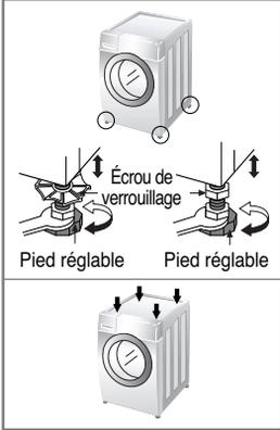
2. Si le sol est inégal, régler les pieds de mise à niveau (ne pas insérer de cales de bois, etc ... sous les pieds). S'assurer que les quatre pieds sont stables et reposent sur le sol. Vérifier ensuite que l'appareil est parfaitement à niveau (utiliser un niveau à bulle d'air).
