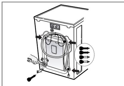
1. Les 4 vis spéciales sont serrées pour prévenir tous dommages internes pendant le transport. Avant de faire fonctionner la machine à laver, enlever les vis ainsi que les rondelles en caoutchouc.
